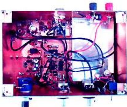
Binnenwerk 20 meter zendontvanger. De ontvanger zit in het blikje. Het geheel is gebouwd in hooibergconstructie.
